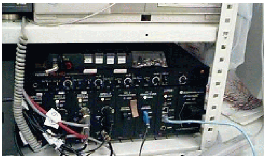
KUINS-II/ATM に接続された MPEG2 ビデオコーデック装置 (総合情報メディアセンター)
