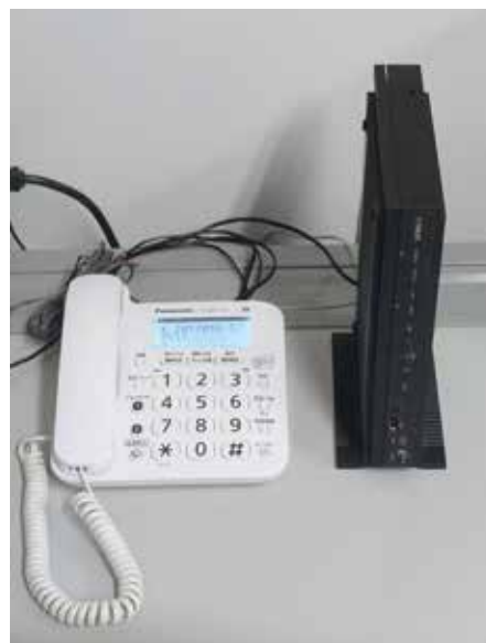
写真2: YAMAHA RT58iとアナログ電話機の着信履歴表示
